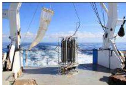
Rosette CTD et filet à plancton sur le pont du Téthys. © E. Diamond
